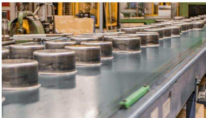
Emboutissage réalisé à partir d'une feuille d'aluminium
